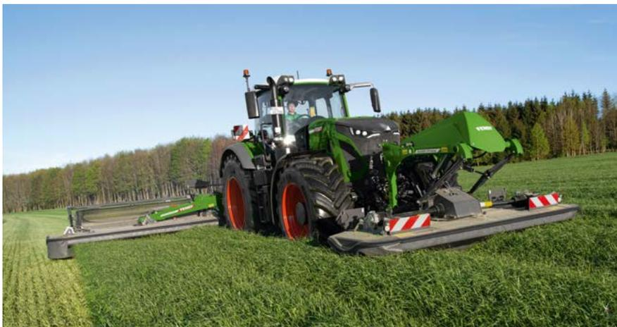
Die neuen DLG prämierten Fendt Slicer Heckmähwerke im schlagkräftigen Gespann. Grünfuttertechnik mit dem Fendt Faktor.
